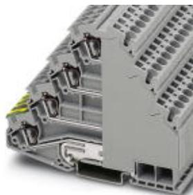
Borne para motores, cuatro pisos, tipo de conexión: conexión por resorte, sección transversal: 0,08 mm<sup>2</sup> - 6 mm<sup>2</sup>, AWG: 28 - 10, ancho: 6,2 mm, color: gris, tipo de montaje: NS 35/7,5, NS 35/15
