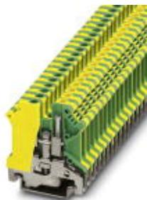
Borne de tierra para carril, Tipo de conexión: Conexión por tornillo, N° de polos: 1, Sección: 0,2 mm<sup>2</sup> - 6 mm<sup>2</sup>, AWG: 24 - 10, Anchura: 6,2 mm, Color: amarillo-verde, Tipo de montaje: NS 35/7,5, NS 35/15, NS 32
