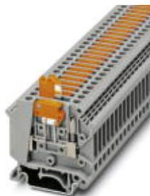
Borne interrumpible por cuchilla, con hembras roscadas para tomas de prueba para alojar clavijas de prueba, Tipo de conexión: Conexión por tornillo, Sección: 0,2 mm<sup>2</sup> - 6 mm<sup>2</sup>, AWG: 24 - 10, Corriente nominal: 16 A, Tensión nominal: 500 V, Longitud: 51 mm, Anchura: 6,2 mm, Color: gris, Montaje: NS 32, NS 35/7,5, NS 35/15
