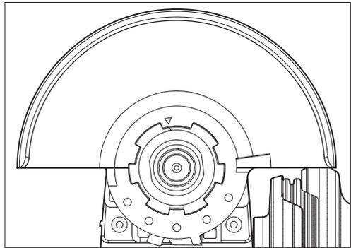
4. Para **instalar** el protector, retire la batería y quitar todos los accesorios del vástago.
