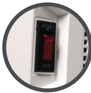
Interruptor de encendido y breaker de sobrecarga.
