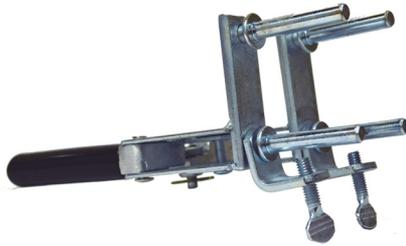
① Acoplar las partes del molde e insertar los pernos dentro de los barrenos del molde
