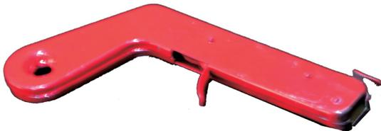
① Acercar el chispero a la entrada del molde y jalar el gatillo para realizar la ignición de la soldadura.
