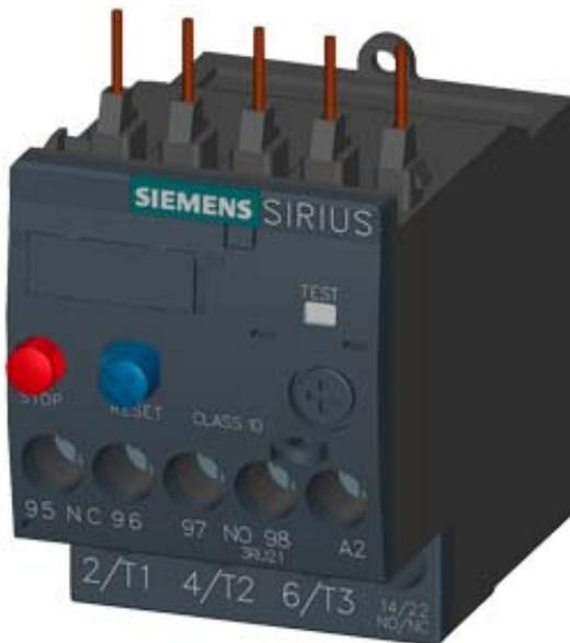
RELE SOBRECARGA 1,1...1,6 A PARA PROTECCION DE MOTORES TAM. S00, CLASE 10, INSTALACION SOBRE CONTACTOR CIRC. PPAL.: BORNES TORNILLO CIRC. AUXL.: BORNES TORNILLO REARME MANUAL-AUTOMATICO
