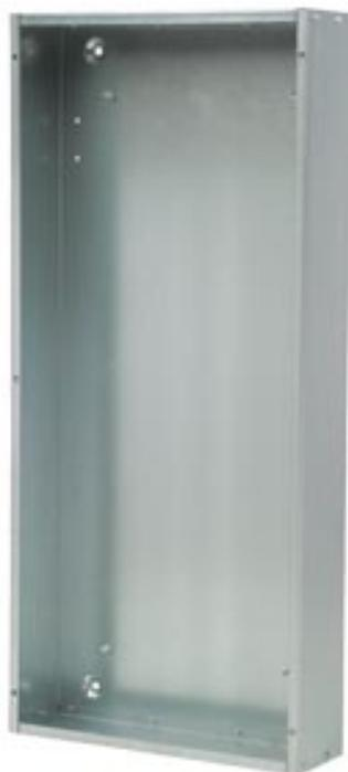
Siemens Low Voltage sin ensamblar, Panel de iluminación piezas/accesorios. Calibre 16 caja de acero; acero calibre 14 frontal, construcción tipo 1 acabado estándar envolvente (montaje en caja). Dimensiones (al. x an. x pr.) in: 62 x 20 x 5,75. Características especiales: tipo frontal: c. cerradura FAS.
