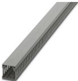
Canal de cableado para la instalación y el montaje en armarios de control, gris, formado por parte superior e inferior, ancho: 40 mm, altura: 40 mm, longitud: 2000 mm
