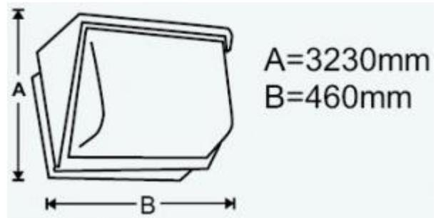
Luminario para muro existente en tres tamaños diferentes para 175w ,250w y 400w se pueden usar en aditivos metálicos, vapor de sodio ,hqi y vapor de mercurio.
