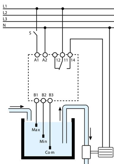
Los controles de nivel de la serie 72 funcionan midiendo la resistencia a través del líquido entre la sonda del común (B3) y las sondas de Mín. (B2) y Máx. (B1). Tanques metálicos pueden utilizarse como sonda común (B3) y sustituirlos. Es importante tener en cuenta las características de los líquidos.
