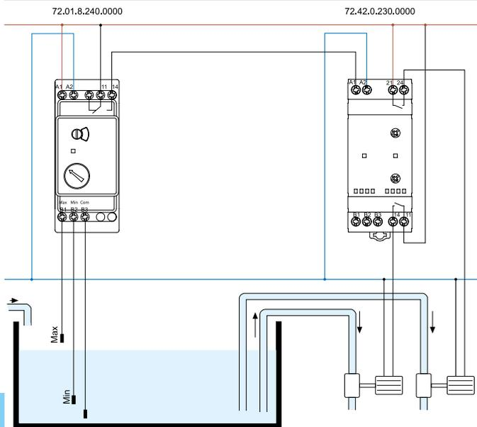
El esquema muestra el funcionamiento de un relé de alternancia 72.42 junto con un único control de nivel de líquidos 72.01. En condiciones normales el nivel del líquido debe mantenerse dentro los límites Mín. y Máx. En este caso la función del 72.42 será repartir y alternar el funcionamiento de ambas bombas. No está previsto para que las bombas funcionen simultáneamente.
