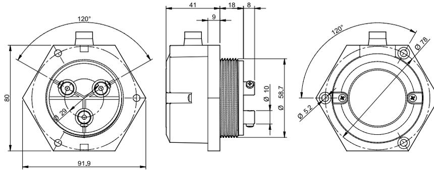
**Electrodo y empalme para electrodos,** empalmar electrodos para alcanzar la longitud necesaria.
