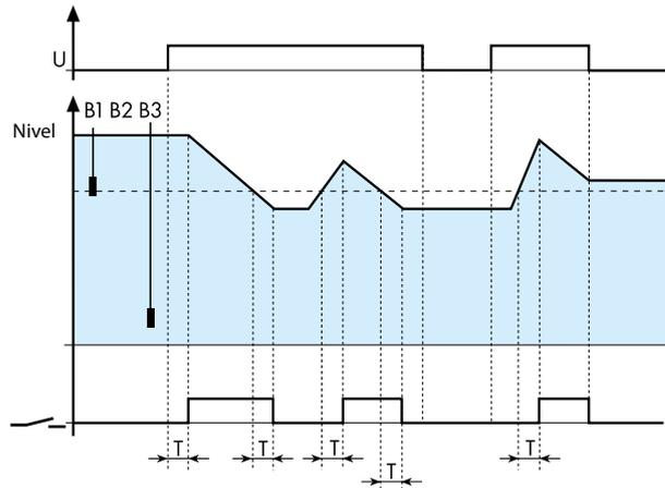
**Control de vaciado** referente a un único nivel, B1.
