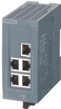
SCALANCE XB005 unmanaged Industrial Ethernet Switch para 10/100 Mbits/s; para configurar pequeñas topologías en estrella y en línea; diagnóstico LED, IP20, 24 V AC/DC fuente de alimentación, con 5 10/100 Mbit/s Twisted Pair Ports con conectores hembra RJ45; manual disponible para su descarga .
