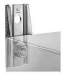
El kit de brackets de montaje instalables en el campo. Brackets de acero inoxidable tienen clasificación Tipo 4X. Juego de cuatro (4) brackets pueden soportar 227 kg (500 lb.) de carga máxima. Se incluyen todos los accesorios. Cuatro brackets por kit.
