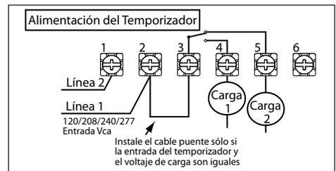
**ET1715CMX configurado para cambio de cargas SPDT**
