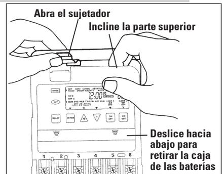
1. Retire el mecanismo de la caja presionando el sujetador de la parte superior de la caja y jalándolo, como se muestra en la imagen. **PRECAUCIÓN: No toque los componentes de la tarjeta de circuitos ya que la descarga estática podría dañar el microprocesador.**
