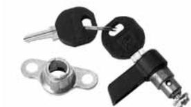
La cerradura de manija puede reemplazar a la cerradura standard ranurada, de cuarto de vuelta en todos los modelos de gabinetes de tapa con bisagra o tapa con ventana. El cerrojo es de zinc fundido. Incluye dos llaves e instrucciones de instalación. Reduce la clasificación de UL de 4 o 4X a 12.
