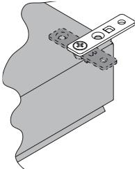
El bracket de montaje puede instalarse in sitio. Acero Inoxidable 316L. Accesorios diseñados para mantener el grado de protección.
