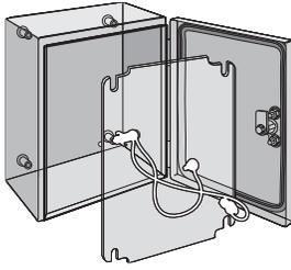
El kit de puesta a tierra provee los medios necesarios para añadir algún conductor de tierra. Al gabinete. El kit incluye dos cables de cobre aislados con una terminal en cada lado, así como tornillería para instalación e instructivo.
