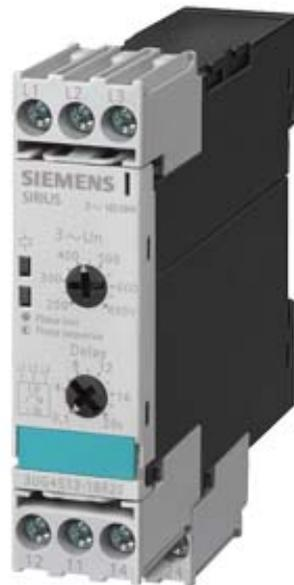
RELES DE VIGILANCIA ANALOG. PERDIDA Y SECUENCIA DE FASES MINIMA TENSION AJUSTABLE DESEQUILIBRIO 20% FIJO 3X 160 A 690V AC 50 A 60 HZ HISTERESIS 5% FIJO RETARDO 0-20S 2 CONTACTOS CONMUTADORES BORNES DE TORNILLO PRODUCTO SUCESOR DE 3UG3013-1A...
