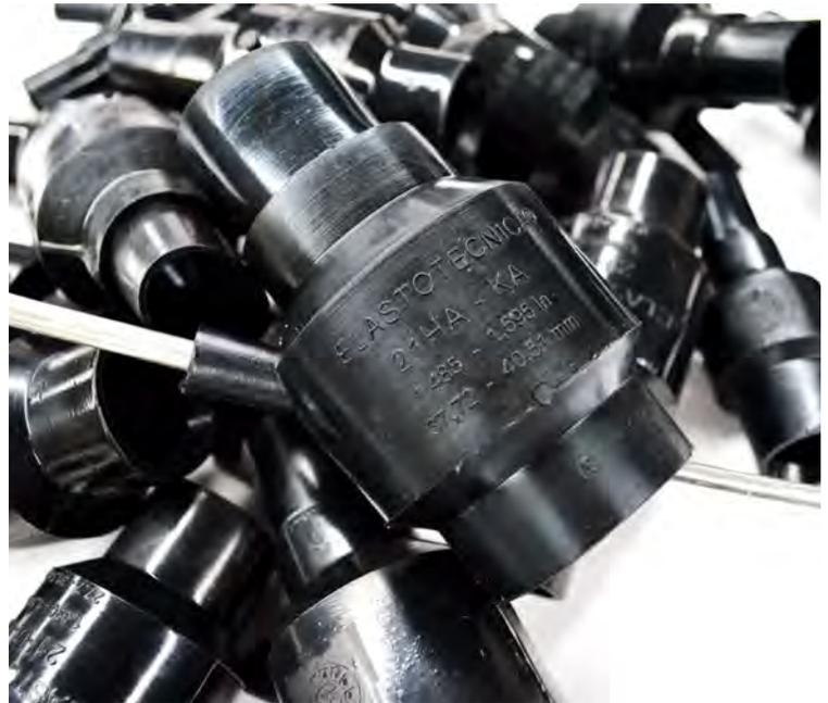
Están diseñados para conectar a tierra cables con pantalla de hilos cuando es usado en conjunto con otros accesorios para distribución subterránea. Este sistema elimina la necesidad de encintar y/o soldar la pantalla de hilos. Para su instalación un conector a tope tipo barril es ponchado para conectar la pantalla de hilos a la varilla de cobre.
