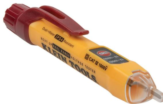
El NCVT-2P es un probador de voltaje sin contacto que detecta de 12 a 1000 V CA e indica la presencia de voltaje en cables, cables conductores, cortacircuitos, accesorios de iluminación, interruptores, tomacorrientes y alambres, así como voltaje CA en timbres, termostatos, luces de bajo voltaje y sistemas de riego. Incluye señales visuales y audibles. El NCVT-2P es lo suficientemente resistente para cualquier lugar de trabajo.
