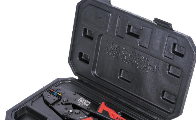
El juego de pinzas ponchadoras de ciclo completo poncha terminales de cable 10-22 AWG con aislamiento, sin aislamiento, termocontraíbles y de férula. El juego incluye la pinza ponchadora, cuatro matrices ponchadoras intercambiables y un estuche para transporte. Cada matriz ponchadora cuenta con múltiples cavidades de ponchado diseñadas especialmente para cada tipo de terminal.
