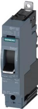
interruptor automático 3VA4 UL Frame 125 clase de poder de corte M 35 kA a 277 V de 1 polo, protección de distribuciones TM210, FTFM,  $I_{n}=15$  A protección contra sobrecarga  $I_r=15$  A con ajuste fijo protección contra cortocircuitos  $I_{li}=20 \times I_n$  conexión en borne
