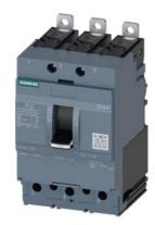
interruptor automático 3VA4 UL Frame 125 clase de poder de corte S 25 kA a 480 V de 3 polos, protección de distribuciones TM210, FTFM, In=100 A protección contra sobrecarga Ir=100 A con ajuste fijo protección contra cortocircuitos Li=10 x In conexión en borne
