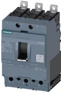
interruptor automático 3VA4 UL Frame 125 clase de poder de corte S 25 kA a 480 V de 3 polos, protección de distribuciones TM210, FTFM,  $I_n=60$  A protección contra sobrecarga  $I_r=60$  A con ajuste fijo protección contra cortocircuitos  $I_c=10 \times I_n$  conexión en borne
