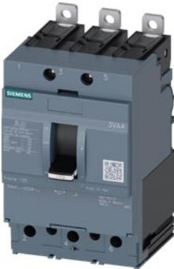
interruptor automático 3VA4 UL Frame 125 clase de poder de corte S 25 kA a 480 V de 3 polos, protección de distribuciones TM210, FTFM, In=50 A protección contra sobrecarga Ir=50 A con ajuste fijo protección contra cortocircuitos Li=10 x In conexión en borne
