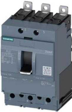
interruptor automático 3VA4 UL Frame 125 clase de poder de corte S 25 kA a 480 V de 3 polos, protección de distribuciones TM210, FTFM, In=15 A protección contra sobrecarga Ir=15 A con ajuste fijo protección contra cortocircuitos Ii=20 x In conexión en borne
