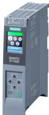
SIMATIC S7-1500, CPU 1513-1 PN, módulo central con memoria central 300 KB para programa y 1,5MB para datos, interfaz 1: PROFINET IRT con 2 Port Switch, 40 ns bit-performance, requiere SIMATIC Memory Card
