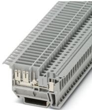
Borne de paso, La corriente y la tensión son determinadas por el conector empleado., tensión nominal: 800 V, corriente nominal: 23 A, 1er piso, conexión a la derecha, tipo de conexión: Conexión por tornillo, Sección de dimensionamiento: 2,5 mm<sup>2</sup>, sección: 0,2 mm<sup>2</sup> - 4 mm<sup>2</sup>, montaje: NS 35/7,5, NS 35/15, color: gris
