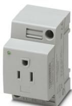
Toma de corriente, Cara enchufable tipo AB 15A, Conexión por tornillo, para EE.UU. y otros países, con indicador luminoso, gris, para el montaje sobre carril en la interfaz de servicio o montaje directo, 125 V AC, 15 A, -20 °C, 60 °C, UL 508
