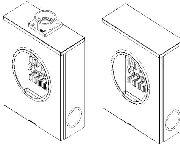
La Base Cuadrada de Medición de 5 mordazas, 200 A, está diseñada para realizar la conexión de la acometida de la compañía que suministra la energía eléctrica y la instalación del equipo de medición (wathorímetro), así como la conexión de ésta a los equipos de distribución (interruptor de seguridad, centro de carga, tablero de alumbrado, etc.) en instalaciones residenciales o comerciales.
