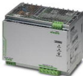
Fuente de alimentación QUINT POWER conmutada en primario para montaje sobre carril con tecnología SFB (Selective Fuse Breaking), entrada: monofásica, salida: 24 V DC/40 A
