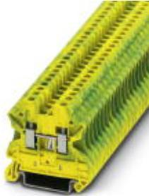
Borne de tierra para carril, Tipo de conexión: Conexión por tornillo, Sección: 0,14 mm<sup>2</sup> - 4 mm<sup>2</sup>, AWG: 26 - 12, Anchura: 5,2 mm, Color: amarillo-verde, Tipo de montaje: NS 35/7,5, NS 35/15
