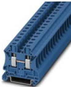
Borne de paso, Tipo de conexión: Conexión por tornillo, Sección: 0,2 mm<sup>2</sup> - 10 mm<sup>2</sup>, AWG: 24 - 8, Anchura: 8,2 mm, Color: azul, Tipo de montaje: NS 35/7,5, NS 35/15
