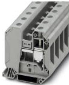
Borne de paso, Tipo de conexión: Conexión por tornillo, Sección: 1,5 mm<sup>2</sup> - 50 mm<sup>2</sup>, AWG: 16 - 1/0, Anchura: 16 mm, Altura: 65,1 mm, Color: gris, Tipo de montaje: NS 35/7,5, NS 35/15
