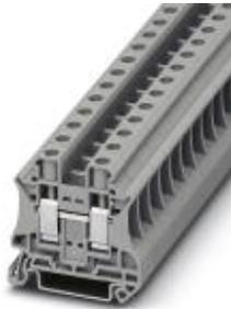
Borne de paso, Tipo de conexión: Conexión por tornillo, Sección: 0,5 mm<sup>2</sup> - 16 mm<sup>2</sup>, AWG: 20 - 6, Anchura: 10,2 mm, Altura: 46,9 mm, Color: gris, Tipo de montaje: NS 35/7,5, NS 35/15
