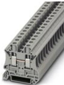
Borne de paso, Tipo de conexión: Conexión por tornillo, Sección: 0,2 mm<sup>2</sup> - 10 mm<sup>2</sup>, AWG: 24 - 8, Anchura: 8,2 mm, Color: gris, Tipo de montaje: NS 35/7,5, NS 35/15
