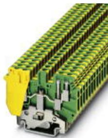
Borne de tierra para carril, conexión doble en cada lado, Tipo de conexión: Conexión por tornillo, N° de polos: 1, Sección: 0,2 mm<sup>2</sup> - 6 mm<sup>2</sup>, AWG: 24 - 10, Anchura: 6,2 mm, Color: amarillo-verde, Tipo de montaje: NS 35/7,5, NS 35/15, NS 32
