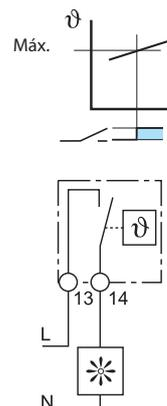
**Desconectar la calefacción** - Cuando la temperatura en el cuadro descienda por debajo de la temperatura fijada (mínima) cerrará el contacto demandando calor. El contacto abrirá cuando se exceda la temperatura fijada.
