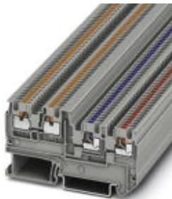
Borne para detectores/actuadores, tensión nominal: 250 V, corriente nominal: 13,5 A, tipo de conexión: Conexión push-in, número de conexiones: 4, sección: 0,14 mm<sup>2</sup> - 1,5 mm<sup>2</sup>, AWG: 26 - 14, anchura: 3,5 mm, color: gris, clase de montaje: NS 35/7,5, NS 35/15
