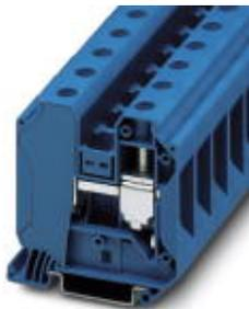
Borne de paso, Tipo de conexión: Conexión por tornillo, Sección: 1,5 mm<sup>2</sup> - 50 mm<sup>2</sup>, AWG: 16 - 1/0, Anchura: 16 mm, Altura: 65,1 mm, Color: azul, Tipo de montaje: NS 35/7,5, NS 35/15
