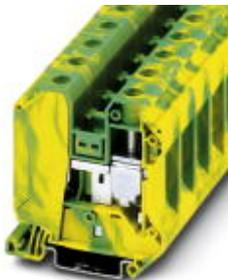
Borne de tierra para carril, Tipo de conexión: Conexión por tornillo, Sección: 1,5 mm<sup>2</sup> - 35 mm<sup>2</sup>, AWG: 16 - 2, Anchura: 16 mm, Altura: 65,1 mm, Color: amarillo-verde, Tipo de montaje: NS 35/7,5, NS 35/15
