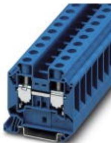
Borne de paso, Tipo de conexión: Conexión por tornillo, Sección: 1,5 mm<sup>2</sup> - 25 mm<sup>2</sup>, AWG: 16 - 4, Anchura: 12,2 mm, Altura: 54,4 mm, Color: azul, Tipo de montaje: NS 35/7,5, NS 35/15
