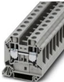
Borne de paso, Tipo de conexión: Conexión por tornillo, Sección: 1,5 mm<sup>2</sup> - 25 mm<sup>2</sup>, AWG: 16 - 4, Anchura: 12,2 mm, Altura: 54,4 mm, Color: gris, Tipo de montaje: NS 35/7,5, NS 35/15
