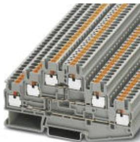
Borne multipiso, Sección: 0,14 mm<sup>2</sup> - 4 mm<sup>2</sup>, AWG: 26 - 12, Tipo de conexión: Conexión push-in, Anchura: 5,2 mm, Color: gris, Tipo de montaje: NS 35/7,5, NS 35/15
